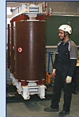
Le transformateur 2200 KVA
